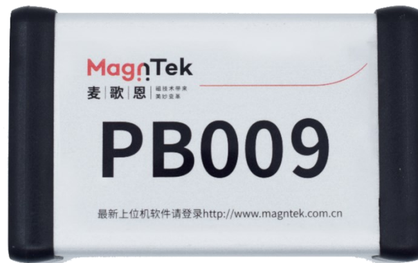
图 1.1 PB009-MT6701CT 编程器主机
